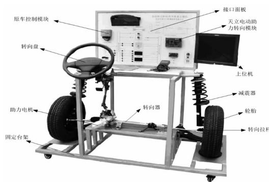
图 1 电动助力转向在环仿真实验台
